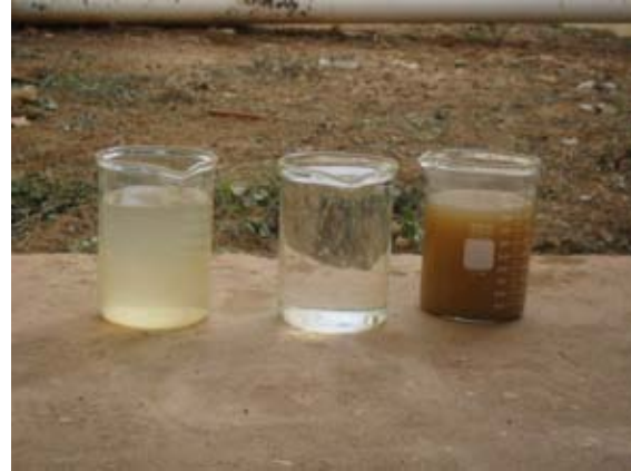
De gauche à droite : eau du fleuve Niger (eau brute) eau traitée par MF/UF (perméat) eau de rejet (concentrat)
